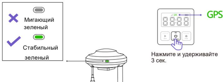
В целях обеспечения стабильного сигнала RTK, расположите станцию RTK на открытой местности, свободной от объектов, вызывающих помехи RTK сигнала, такие как деревья, навесы и здания.
