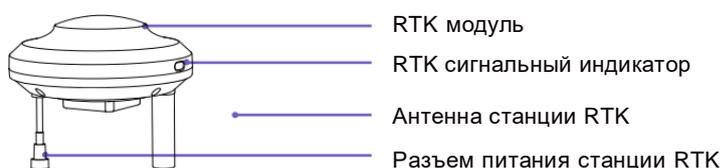
**ВНИМАНИЕ:** Перед установкой станции RTK, произведите поиск RTK сигнала. Найдите точку, где сигнал RTK стабилен, основываясь на показателях сигнального индикатора RTK. Установите станцию RTK. После установки станции RTK, отключите аккумулятор и присоедините станцию RTK к источнику питания.
